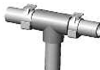
vast punt ter hoogte van een T-stuk
